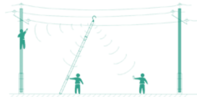
Рис. 1. Применение указателя напряжения УВН «Радуга»
