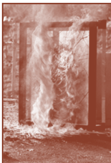
Испытания противопожарного стекла
